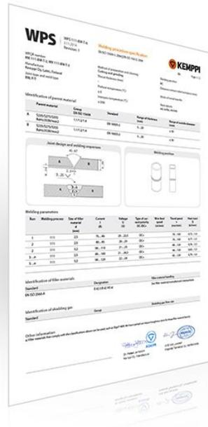
包含 8 套焊接工艺规范，都是专为针对结构管材对接接头的对接焊接而特别开发的。
